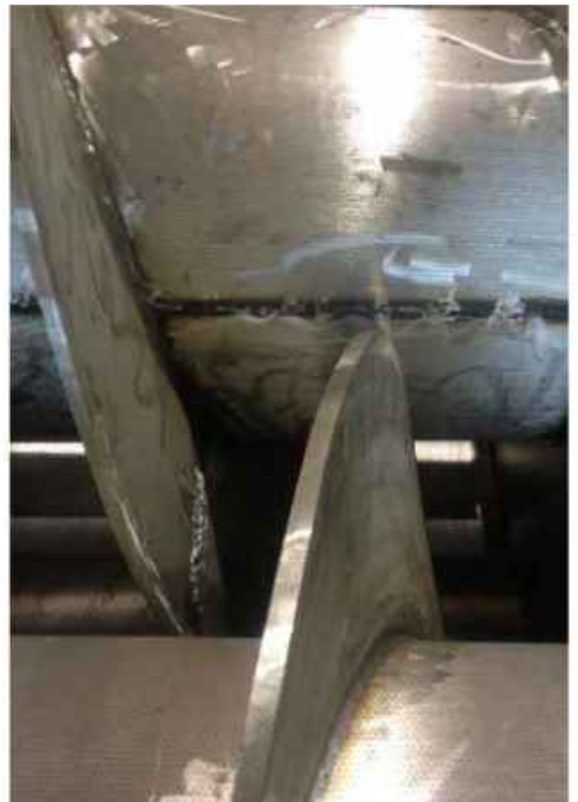
Self-draining high quality steel press spindles Vis de presse auto-drainant en acier de haute qualité Sinfines de prensado auto-drenantes en acero de alta calidad
